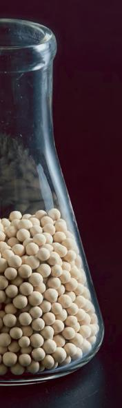
در برابر اصطکاک و مقاومت در برابر آلوده کنندهها اشاره کرد، که باعث افزایش راندمان و زمان کارائی این مـدل میشود.این غربالهـای مولکولی جهـت خشـک کـردن مـوادی ماننــد اتانـول، هـوا، گازهـای سرماسـاز، گاز طبیعـی، هیدروکربنهـای غیـر اشـباع اسـتفاده میشـود.
